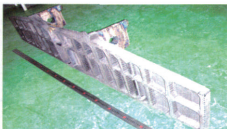
图2 激光快速成形TA15钛合金飞机主承力梁 (1730 mm × 250 mm × 230 mm)
